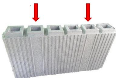
**Unire i singoli pannelli**, fino a raggiungere l'altezza necessaria, Tagliare l'ultimo pannello, in modo che l'elemento, formato dalla sovrapposizione dei vari blocchi dell'elemento Divisorio, sia largo 60 cm e 2 cm più corto dell'altezza tra il piano ed il soffitto. Inserire gli elementi metallici negli alloggi da 5 x 5 cm che presentano le scritte **CARBON ED** all'esterno, saranno nella seconda e quinta cavità delle sei che hanno i blocchi.
